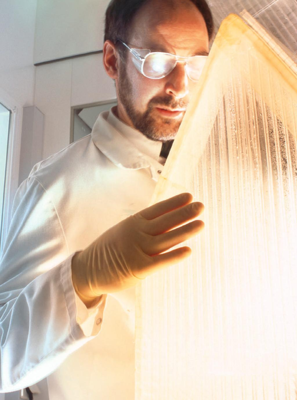
Las láminas Makrolon® cuentan con una capa de protección para contrarrestar los efectos de intemperización producidos por los rayos UV, lo que garantiza una resistencia al envejecimiento y mantiene todas sus características a lo largo del tiempo.
